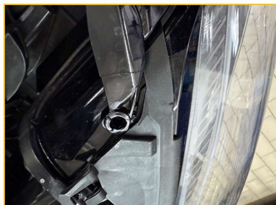
Bilder 1+2 Werkstattbilder Mercedes Benz CLA Typ 174 vollelektrisch, Scheinwerfer Multibeam LED / Führungsstift
